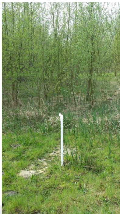
Foto: Monitoringsvoorziening kwetsbaar: peilbuis zonder mantelbuis.
