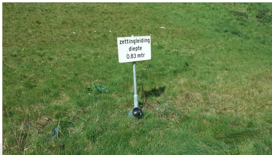
Foto: Duidelijk markering zettingsleiding.
